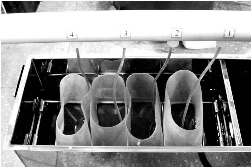
Рис. 8.13. Перчатки, подготовленные к испытанию.
